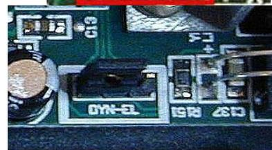
**NOTA:** I microfoni dielettrici a condensatore devono essere collegati ad entrambi i poli di uno spinotto STEREO da 3,5mm. Il **plug mono non funziona con SN#900** o superiori. Chiudere il jumper in posizione **IC**
